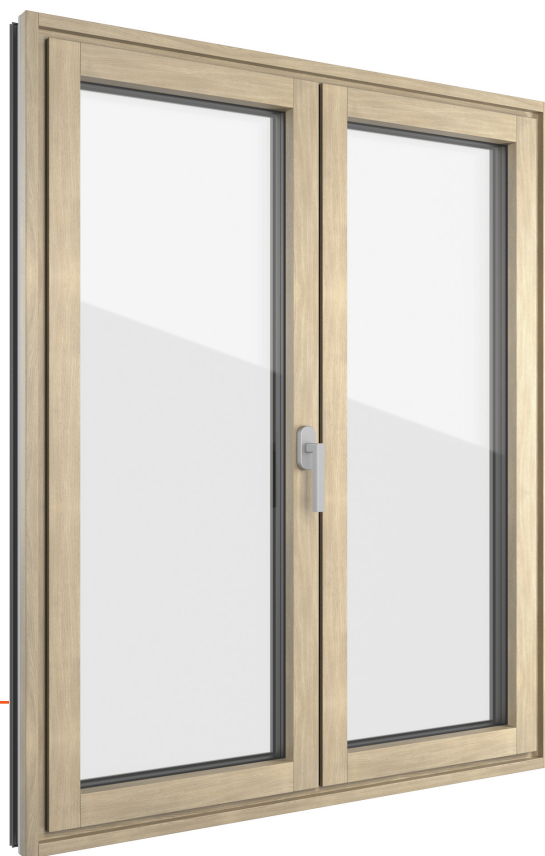
Figura: versão de duas folhas com aro e folha faceados pelo interior, exterior em alumínio DB703 Antracite metalizado mate e interior em madeira Carvalho natural 2X01
